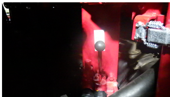
●油圧切り替え(上がレッカー、中がクレーン、下は不使用) 位置はクレーン左アウトリガー内側
